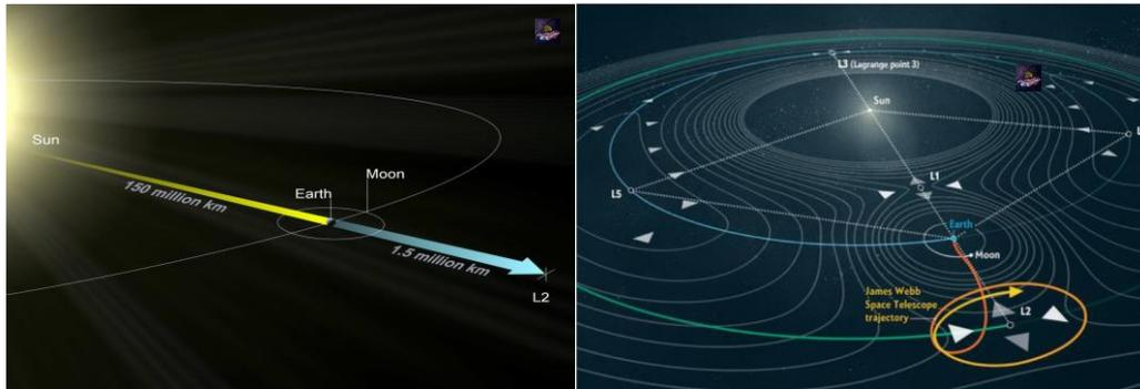
FIGURA 3. Puntos de Lagrange y órbita de Halo del Telescopio Espacial James Webb alrededor del punto L2 ([https://repositorio.aemet.es/bitstream/20.500.11765/13840/1/ACTA\\_Solis\\_telescopio.pdf](https://repositorio.aemet.es/bitstream/20.500.11765/13840/1/ACTA_Solis_telescopio.pdf))
